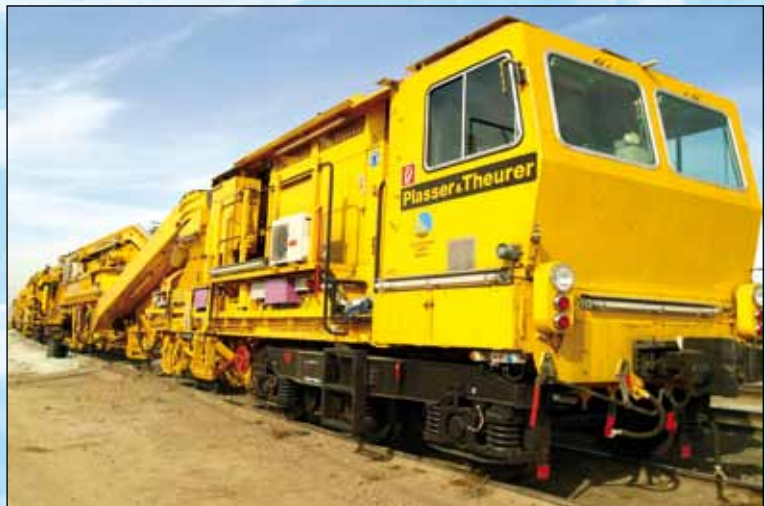
哈铁（哈萨克斯坦）线路上的“普拉塞和陶依尔”公司（铁组加入企业，奥地利）生产的养路机械
