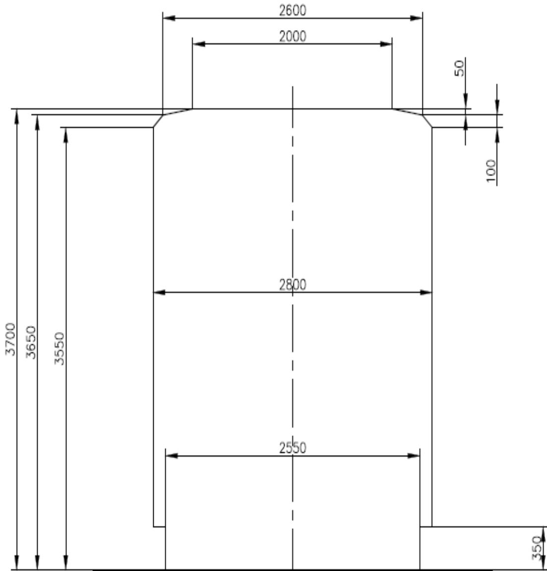
图8 1000mm 轨距铁路装载限界：
