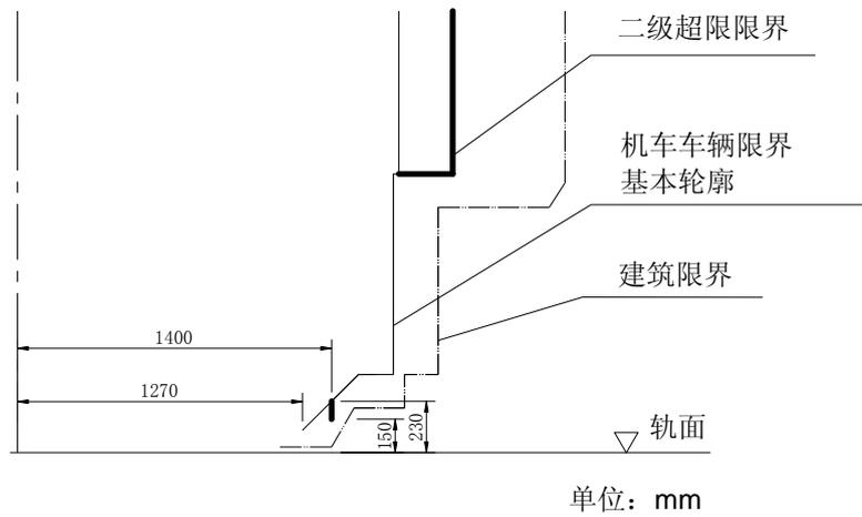
图 5b 1435mm 轨距铁路装载限界：中铁
