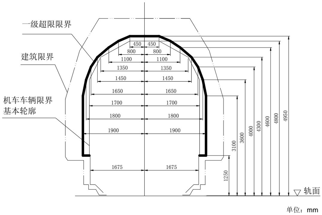
图 5 1435mm 轨距铁路装载限界：中铁
