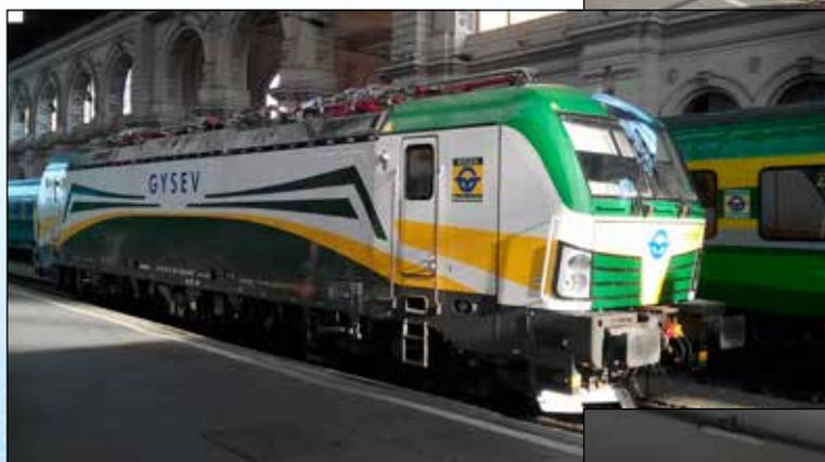
吉肖富铁路（奥地利—匈牙利）上的西门子产Vectron新型电力机车
