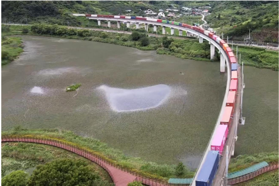
首次在韩国试运行的 50 节编组、777 米长的列车行经韩国铁路桥
